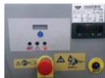
Quadro elettrico con termostato digitale Electrical box with digital thermostat
